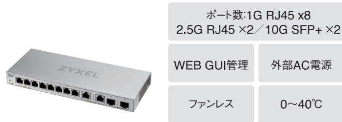
XGS1210-12 WEB管理に対応した ファンレスマルチギガスイッチ
